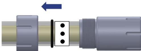
4. Knickschutz lässt sich nun nach hinten schieben, sodass der Anfang des inneren PFA Schlauches frei liegt.
