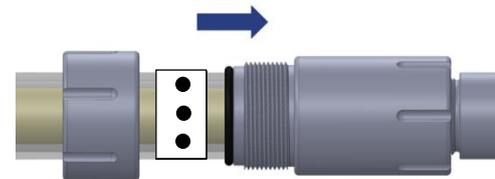
8. Kontermutter auf Knickschutz aufschrauben und festziehen.
