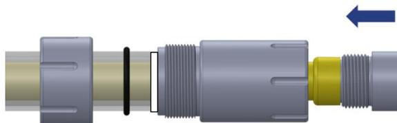
6. Knickschutz auf Flare-Verschraubung bis zum Anschlag aufschrauben und festziehen.
