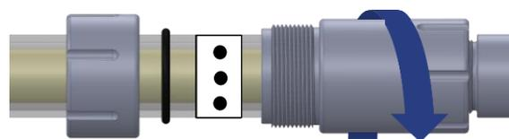
7. O-Ring bündig an Knickschutz anlegen.
