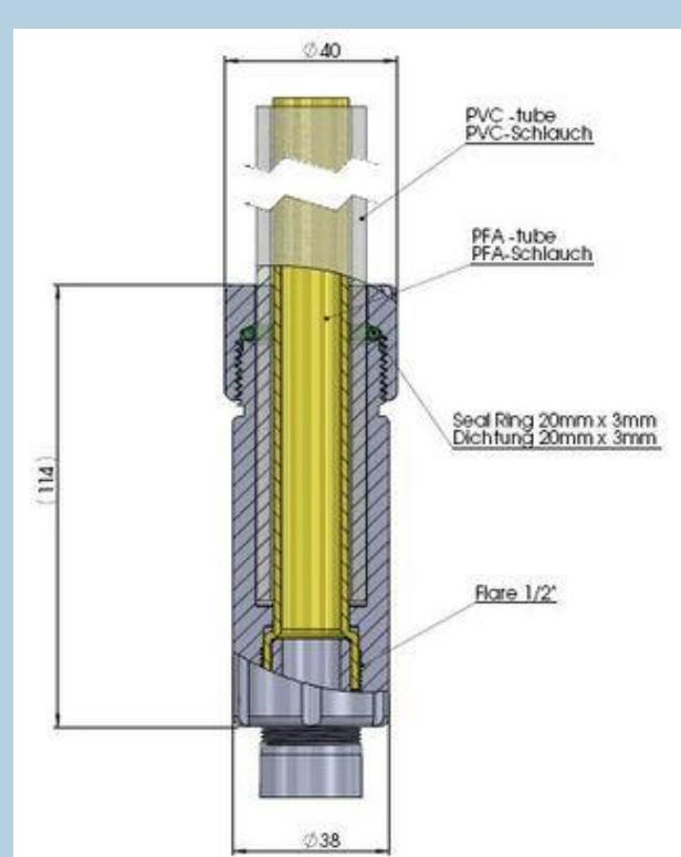
**雙軟管聚四氟乙烯 (PFA) /聚氯乙烯 (PVC) 雙管系統--PVC 管內置 PFA 軟管，兩端帶有扭結保護 Flaretek®靈活連接口！**
