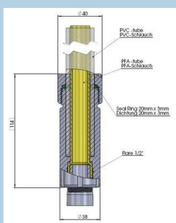
双软管聚四氟乙烯 (PFA) /聚氯乙烯 (PVC) 双管系统 – PVC 管内置 PFA 软管, 两端带有扭结保护 Flaretek® 灵活连接口!
